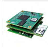
Datenübertragung Mobilfunk/GPS mit Interface Platine, nano-SIM Data transfer mobile/GPS incl. interface board, nano-SIM EKT-910
